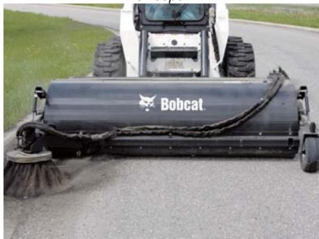
路面のゴミを効率的に掃き込み運搬
