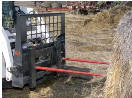
牧草ロールを突き刺して運搬
