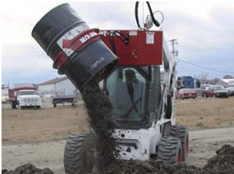
ドラム缶の運搬投入作業に
