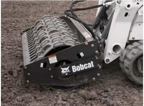
振動ローラーで整地作業の仕上げ
